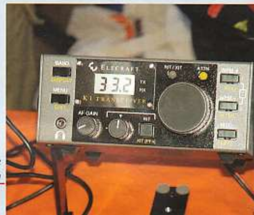
De als bouwpakket verkrijgbare K-1 HF transceiver voor twee banden
